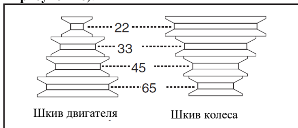
Рисунок 16. Изображение расположения клинового ремня для выбора скорости.
