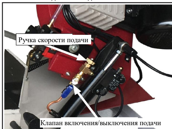
Рисунок 21. Расположение клапана включения/выключения подачи
