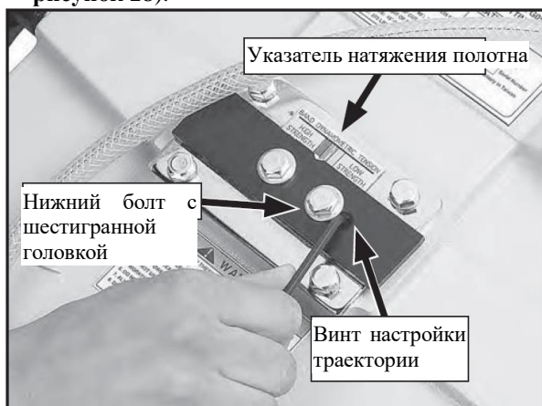
Рисунок 28. Органы регулировки натяжения полотна
